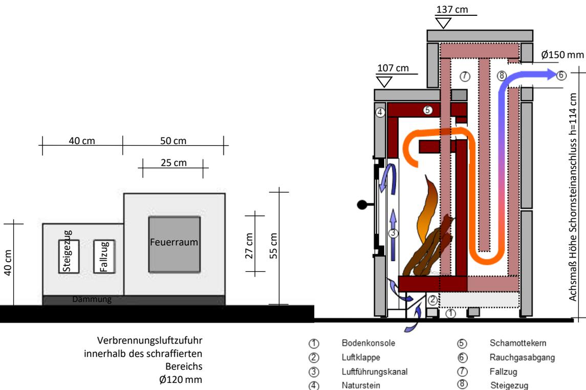
Die Verbrennungsluftzufuhr erfolgt über den Luftführungs kanal und wird oberhalb der Tür in den Brennraum geführt.
