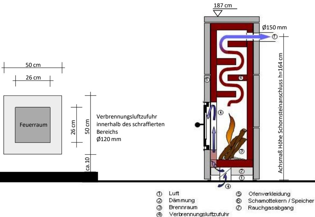
Die Verbrennungsluftzufuhr erfolgt über einen Bodenkanal, der Frischluft von unten in den Ofen führt.
